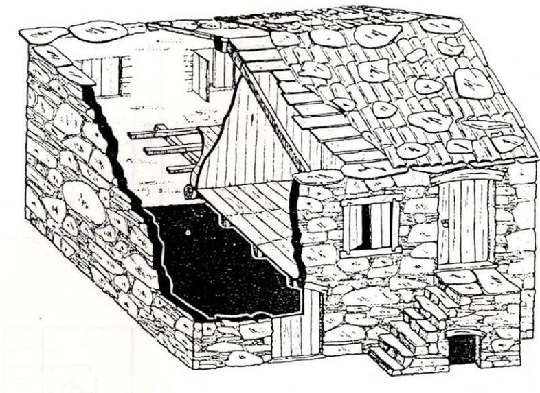
A estrutura destas construções era feita em geral de madeira de castanho ou pinho, sendo a cobertura em barrotes, recobertos inicialmente por colmo e xisto e posteriormente por telha de canudo e beirados em xisto.
